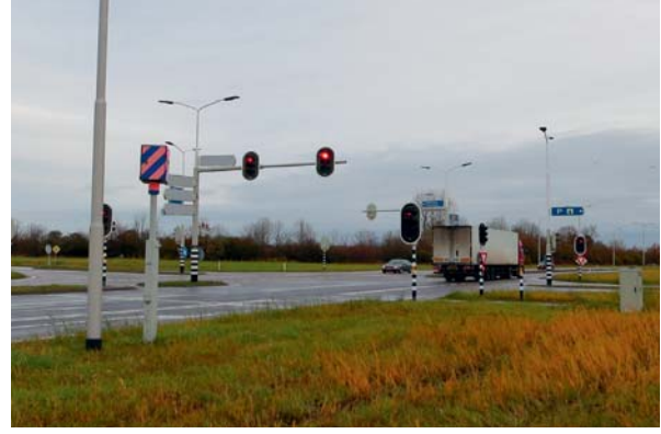
Foto 2: vrachtwagen passeert de VRI nog net voordat deze op rood springt. Links op de foto is de gecombineerde roodlicht en snelheidscamera zichtbaar
