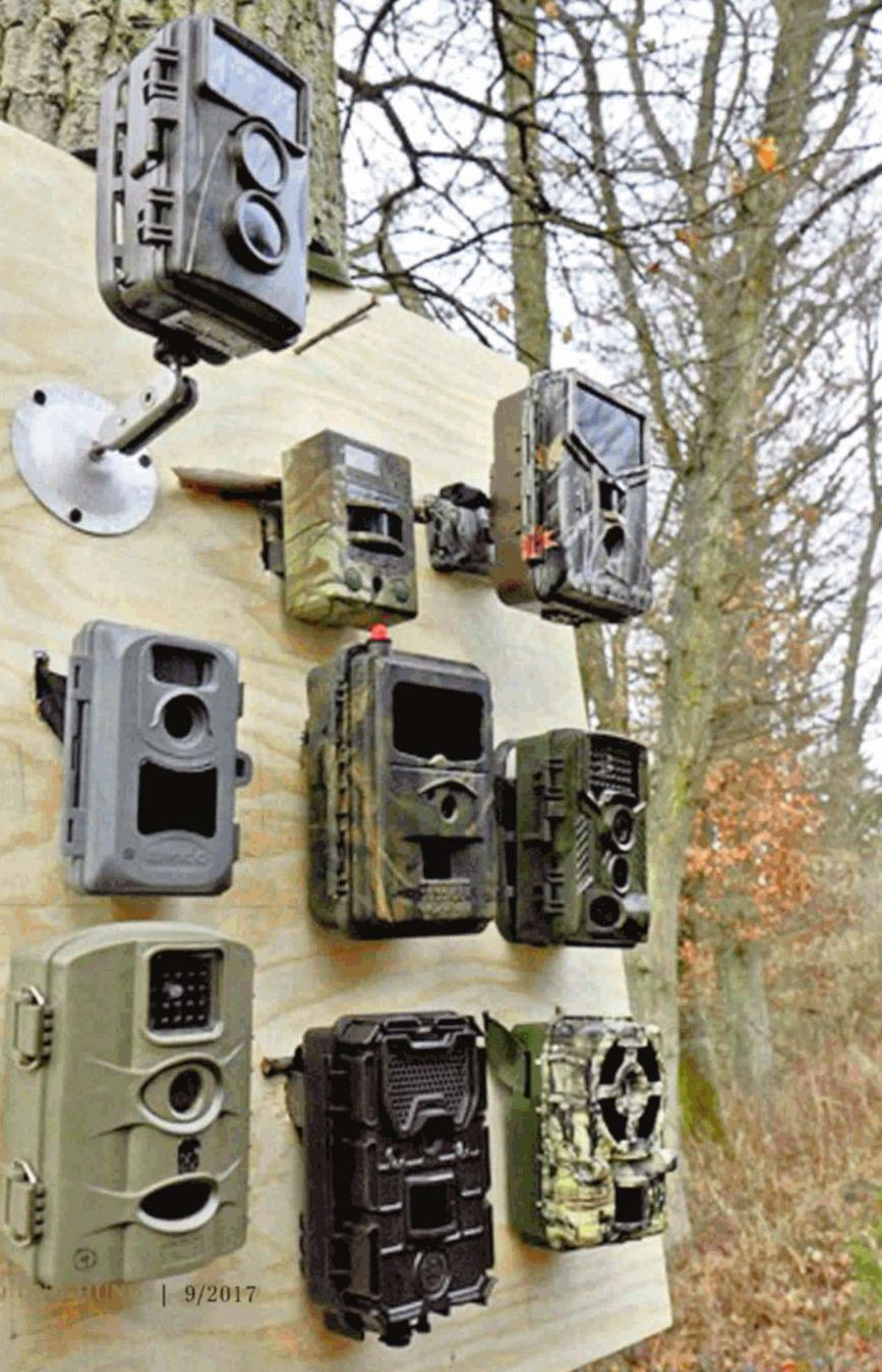
**Wir wollten** den praktischen Wert von neun aktuellen Fotofallenmodellen unter 300 Euro testen. An oberster Stelle standen dabei Bedienbarkeit, Fotoqualität bei Tag und Nacht, Sensorreichweite sowie der Aufnahmebereich in fünf Metern (m) Entfernung von den Geräten. Außerdem haben wir überprüft, ob das Einrichten (Set-up) der Kandidaten verständlich ist.
