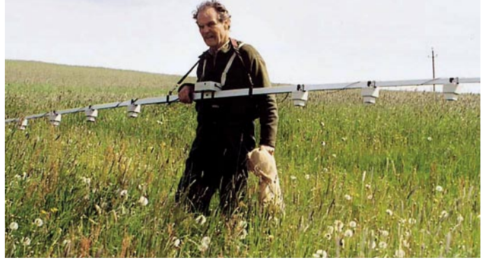
Der ISA Wildretter besteht aus Sensoren an einer Stange. Die Weiterentwicklung zur Montage an modernen Landmaschinen ist hier das Ziel.
