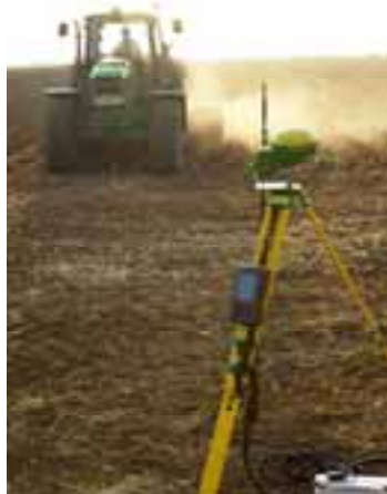
Afbeelding 3.3 mobiel RTK baken
