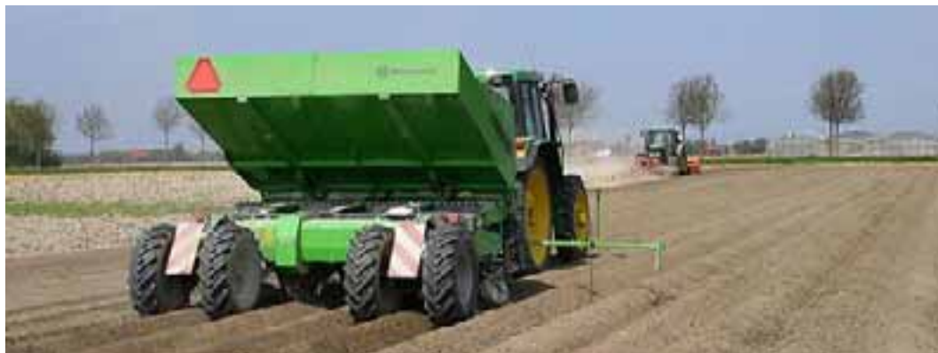
Afbeelding 3.8 Pootafstand variëren op basis van taakkaart mogelijk met Miedema structural
