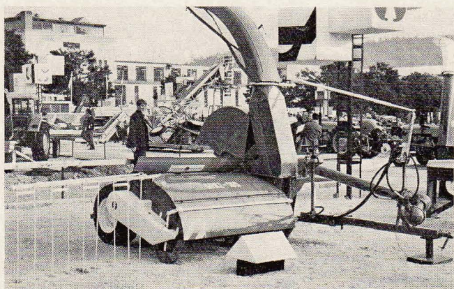
6. Ausleger-Federzinkenkamm als Wildretter am Schlegelfeldhächsler
