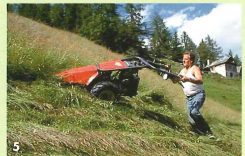
Klassische Mähmaschine mit Messerbalken: der Motormäher. Er wird auch im Berggebiet zunehmend durch die effizienteren Zweiachsmäher abgelöst, v.a. durch Kreiselmäher.
