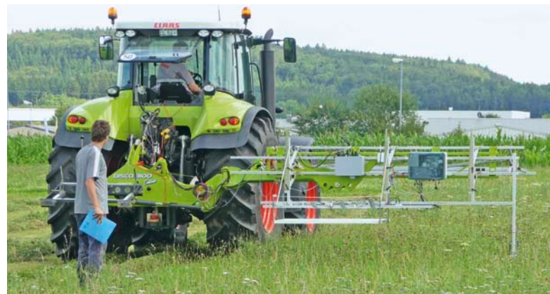
Der Wildretter soll praxistauglich am Auslegerarm eines Schleppers montierbar sein. Wird ein Kitz detektiert, erhält der Fahrer ein Signal.
