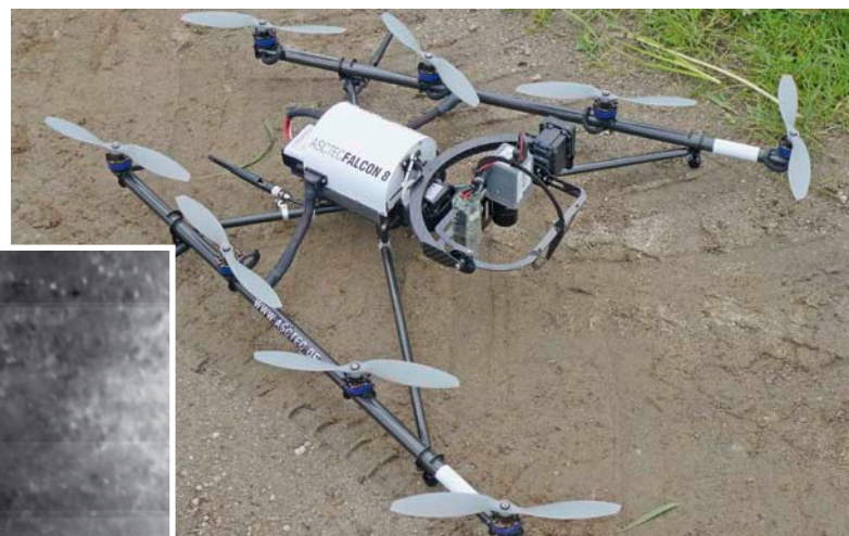
Der ferngesteuerte Oktokopter mit eingebauter Infrarotkamera ermöglicht Aufnahmen von Wildtieren aus der Luft (kleines Wärmebild links).
