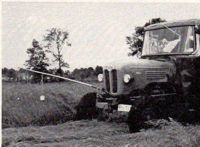
*An dem Zugmaul des Trackers ist die aus einem gebogenen Eisenrohr, einem Tonkingstab sowie Dosen und Bindfaden hergestellte Wildscheuche gut erkennbar. Sie wird in umstehendem Artikel genauer beschrieben*
