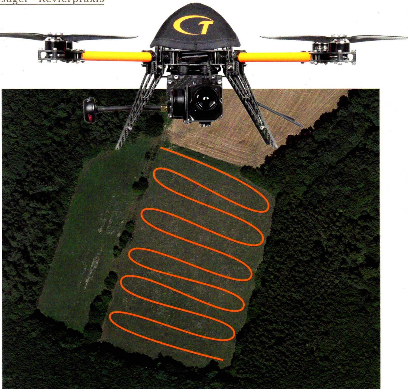
Mithilfe eines speziellen Algorithmus berechnet die Drohne selbstständig ihre Flugbahnen. Die Bilddaten werden an die Empfangseinheit in Echtzeit übermittelt, sodass direkt gesehen werden kann, ob ein Kitz auf der Wiese liegt.
