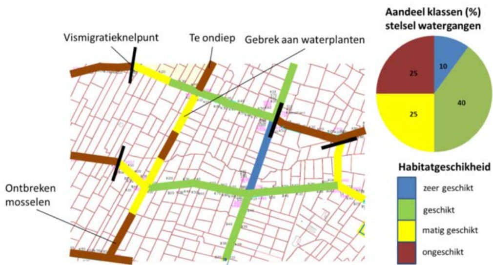
Figuur 4.36 Habitatkwaliteit (fictief voorbeeld) van een stelsel van watergangen op basis van habitatkenmerken (op te nemen in het kennissysteem) in de uitgangssituatie. Voor een aantal ongeschikte of matig geschikte trajecten zijn de knelpunten weergegeven.
