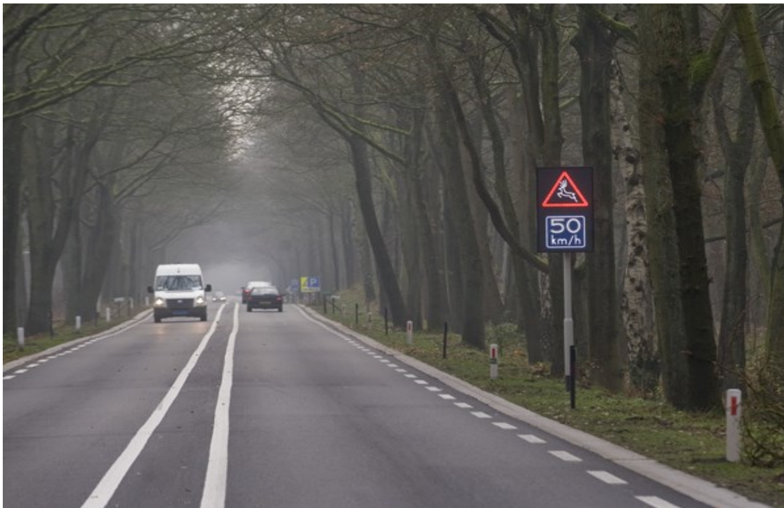
Figuur 6.2 Het gebruik van een wildsignaleringsysteem schijnt een positief effect op een vermindering van het aantal wildaanrijdingen te hebben.
