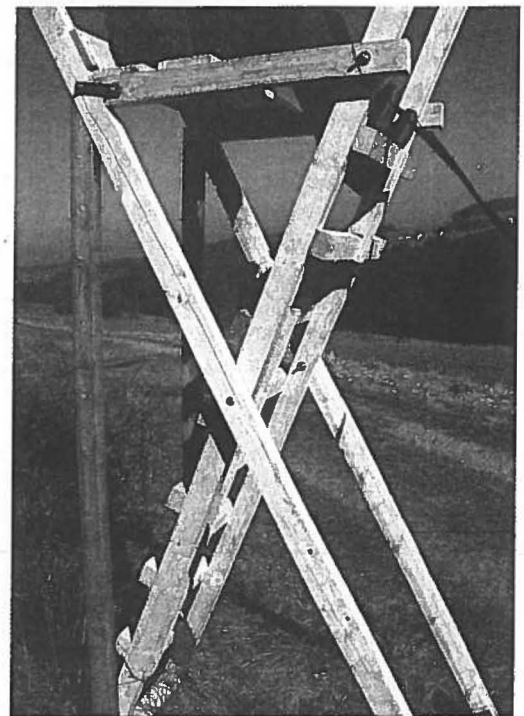
Ein sicherer Stand der Leiter ist erst dann gewährleistet, wenn sie nach allen vier Seiten mit Bodenankern abgespannt wird
