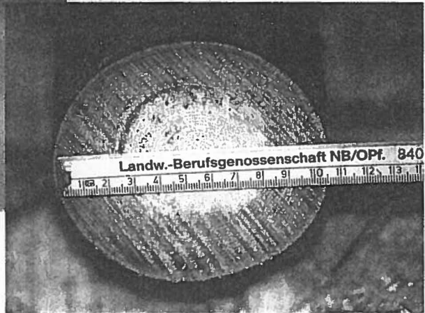
Bei der Fichte oben hat die destabilisierende Rotfäule „zugeschlagen“. Ein solcher Holm wäre lebensgefährlich. Der gesunde Stamm rechts, mit seinem Durchmesser von zehn Zentimetern und seiner Jahrringbreite von etwa einem Millimeter, ist dagegen genau richtig
