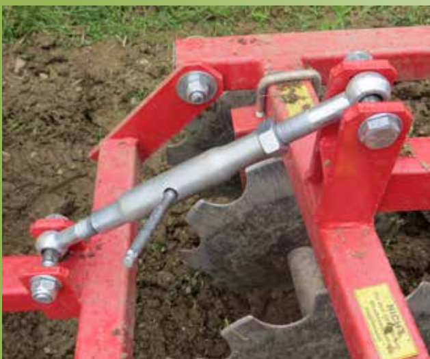
Über eine Spindel kann die Arbeitstiefe festgelegt werden.
