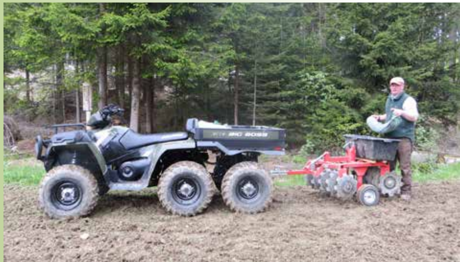
Um schwere Böden zu bearbeiten, einfach eine Mörtelwanne auf die Scheibenegge setzen und Sandsäcke hineinlegen.
